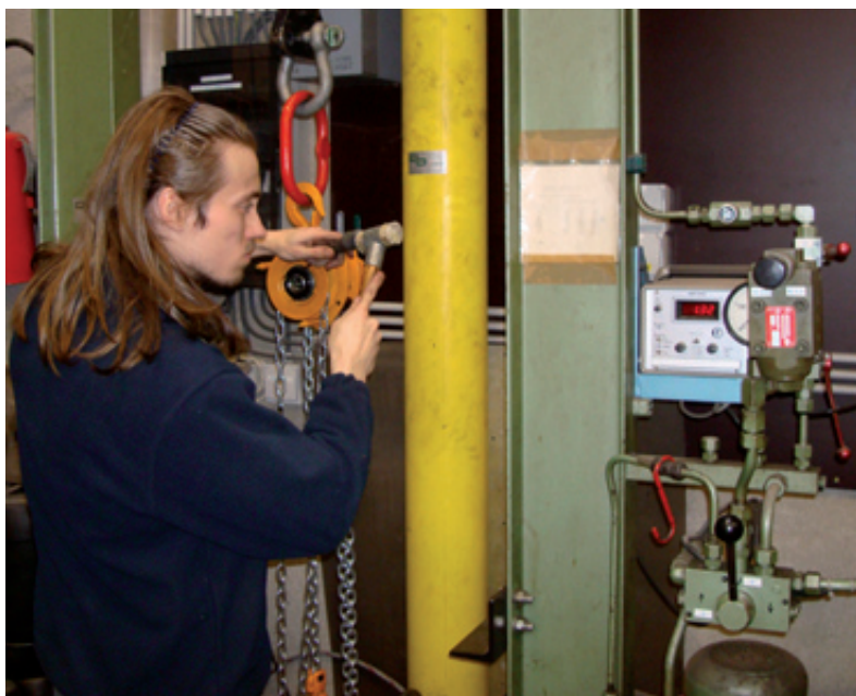
Regeling van de overbelastingbegrenzer, montage en herstelling in ons atelier
