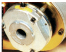
Elektromagnetische schijfrem bij onvoldoende stroom.
