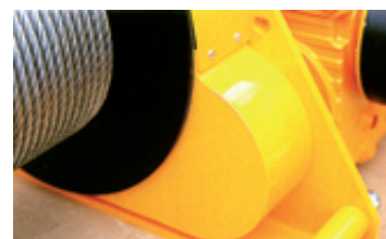
Veiligheid : de mechanische onderdelen zijn afgeschermd.
